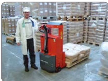
Optimale veiligheid dankzij transparant en schokbestendig veiligheidsscherm en verminderde rijnsnelheid.
