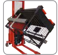
De Rotator kan een box 180° draaien om deze volledig te ledigen, indien er boxhouders met klemmen voorzien zijn.
