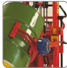
Snel-wissel systeem maakt het gemakkelijk om de vatenkantelaar te vervangen door een van de andere optionele extra's of vorken.
