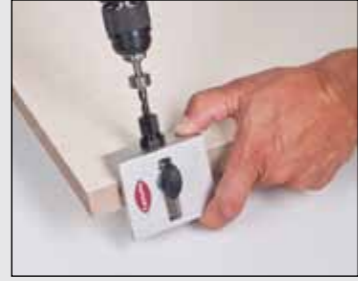
2. De boormaal wordt in de groef geschoven en het bedieningsgat wordt geboord
