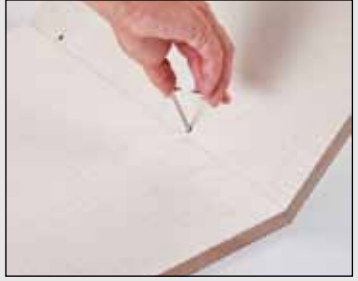
4. Beide werkstukken tegen mekaar duwen, aandraaien en de verbinding is klaar!
