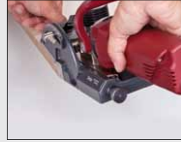
1. Met de Lamello Zeta P2 wordt de profielgroef gefreesd
