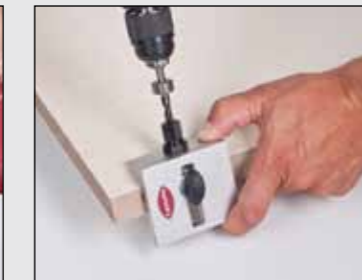
2. Le gabarit est inséré dans la rainure et le perçage est effectué
