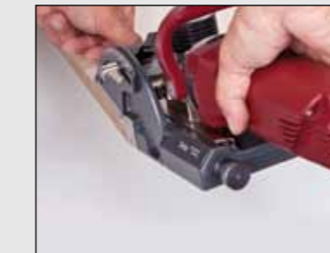
1. La rainure profilée est fraisée avec la Lamello ZetaP2
