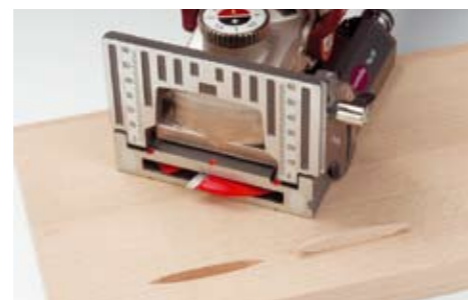
Réparation de bois (fraise pour retirer les poches de résine n° d'art. 01 132217)
