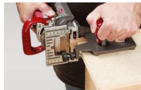
Découpe d'arêtes (dispositif de coupe Nova n° d'art. 01 121280)
