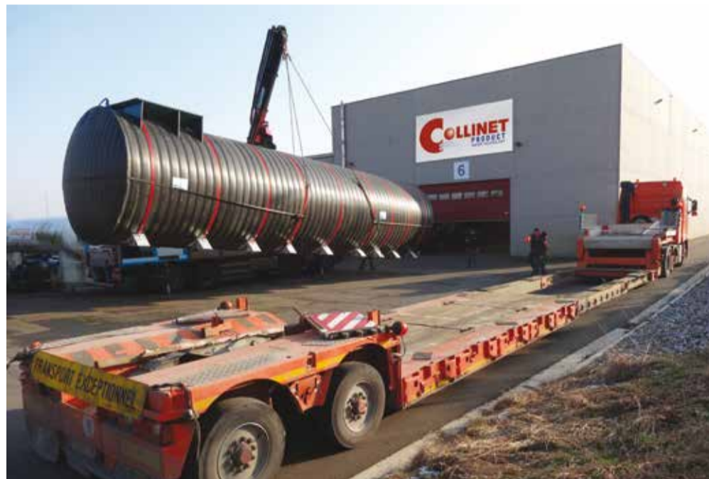
← Chargement du convoi exceptionnel à Herstal : L 14,50 m x Ø 3,3 m
