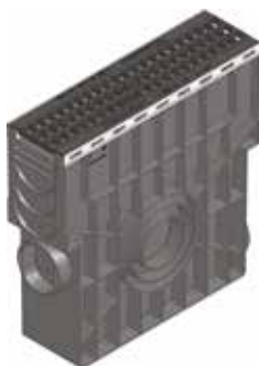
Avaloir avec panier PVC et GUGI caillebotis fonte 15/25, noir, classe C 250, monté et claveté
