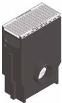
Avaloir avec panier galva et grille caillebotis mailles 30x10, galva, classe B 125, montée et clavetée
